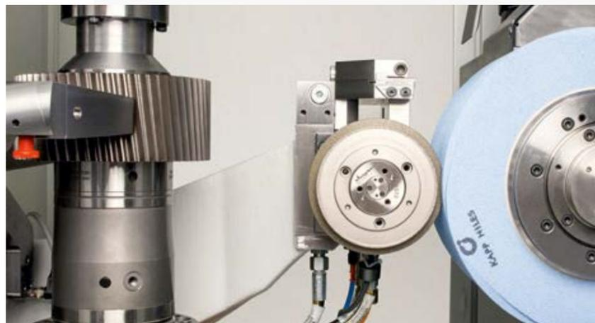
Einsatz abrichtbarer Werkzeuge mit hohen Schnittgeschwindigkeiten
