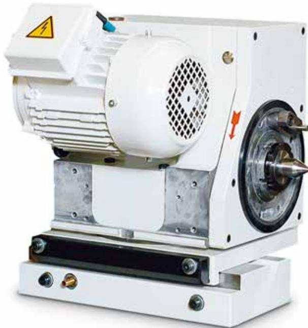
Der schwenkbare hydrodynamisch gelagerte Werkstückspindelstock ermöglicht, sowohl zwischen fest stehenden Spitzen, als auch mit umlaufenden Spindeln zu schleifen. Die kräftige, vom Riemenzug entlastete Werkstückspindel dreht in einer hydrodynamischen Mehrflächen-Gleitlagerung. Die Rundheitsgenauigkeit beim Fliegenschleifen beträgt 0,0003 mm, als Option 0,0001 mm. Der Werkstückspindelstock wird durch einen gestuften AC-Motor angetrieben.
