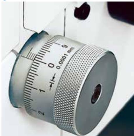
Der starre Reitstock hat eine grosszügig dimensionierte Pinole zur Aufnahme von Spitzen MK3. Die Pinole gleitet in abgedeckten Gleitlagern, der Spitzendruck lässt sich feinfühlig einstellen. Die Feinverstellung erlaubt die schnelle und einfache Zylindrizitätskorrektur (Option), wie sie bei der Bearbeitung von hochpräzisen Werkstücken notwendig ist.
