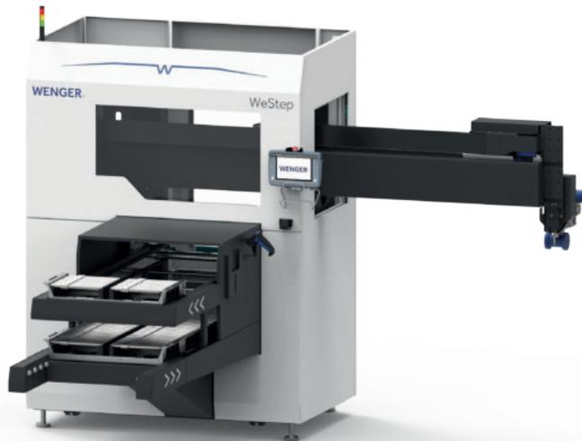
Der WeStep 650 belädt Wellenteile bis 650 mm Länge und Futterteile bis Durchmesser 260 mm.
